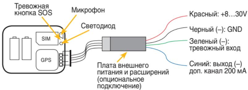
Для вывода жгута проводов на внешнюю плату питания и расширений в корпусе устройства предусмотрено специальное утончение, которое нужно прорезать ножом в случае использования внешних подключений. Утончение расположено в нижней половине корпуса рядом с прорезью для хомутов. Для прорезания отверстия необходимо извлечь платы устройства из корпуса.
