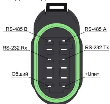
Рисунок 4 Разъем для подключения датчика уровня топлива LLS 20230
